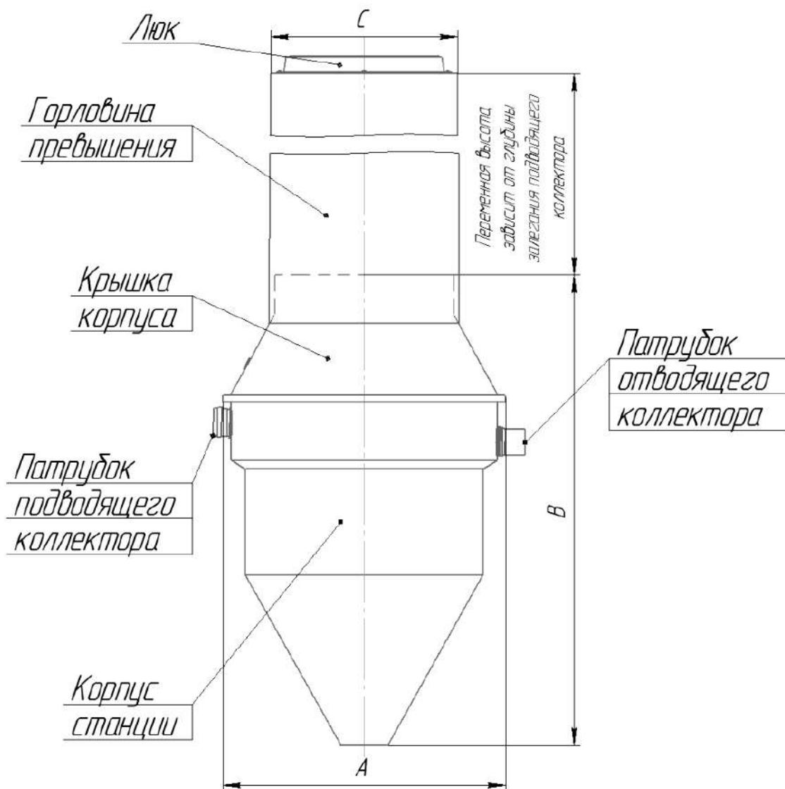
Рисунок 2 – Габаритные размеры и основные части Станции
