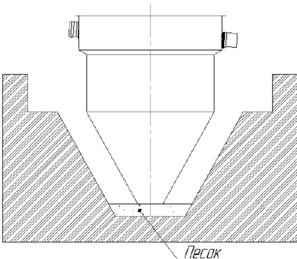
Рисунок 3 – Установка корпуса
