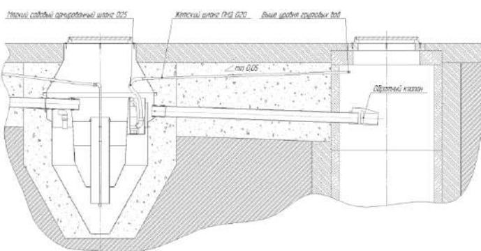
Рисунок 9 – Монтаж Станции с
