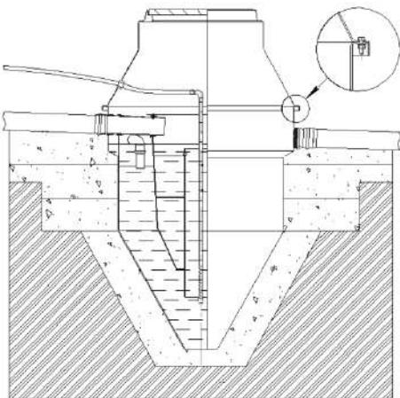
Рисунок 7 – Установка Крышки корпуса
