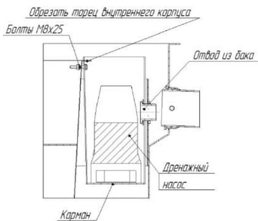
Рисунок 6 – Установка Комплекта для принудительной откачки
