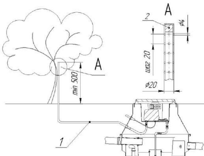
Рисунок 14 – Установка воздуховода
