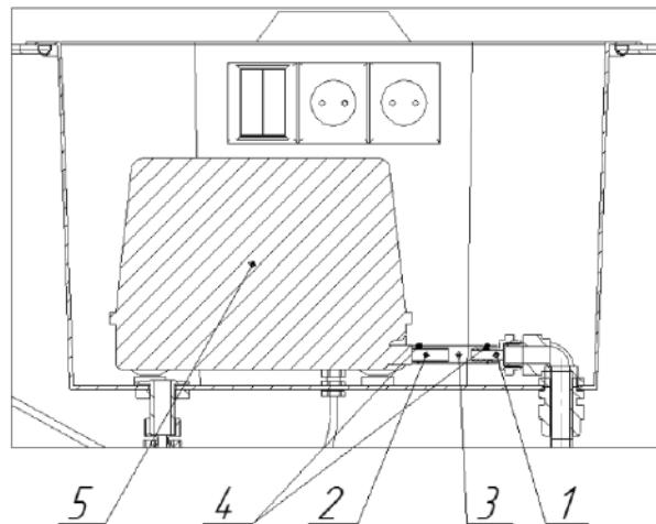
Рисунок 13 – Подключение компрессора
