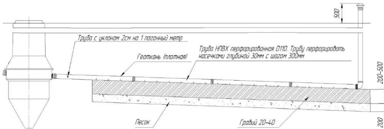
Рисунок 17 – Станция с фильтрационной траншееей
